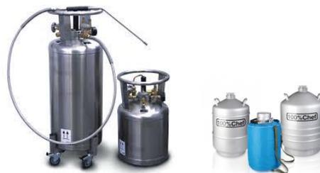
I Dewars possono essere aperti o muniti di tappo con tubo di sfiato o altro dispositivo che permetta lo scarico del vapore ed eviti il formarsi di pressioni troppo elevate. E' buona norma ispezionare frequentemente i dispositivi di scarico dei contenitori per accertarsi che non siano bloccati dal ghiaccio che può formarsi per effetto della condensazione dell'umidità atmosferica.
